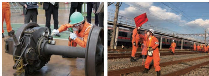
車両部門での技能競技会：車輪の打音検査作業を採点している様子
