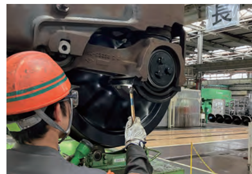
ボルトの打音点検。ボルトの叩き方や工具の握り方の工夫で、不具合をより正確に見極めます
