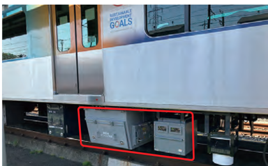
線路設備モニタリング装置
