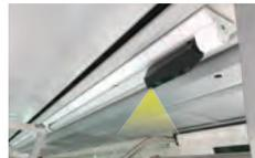
東急電鉄所属の車両に、4Gデータ通信に対応したLED蛍光灯一体型の防犯カメラ「loTube(アイ・オー・チューブ)」を設置し、車両内のセキュリティ向上を図っています。遠隔地からでも映像を確認することができ、車両内のトラブル発生時には、迅速な対応が可能です。
