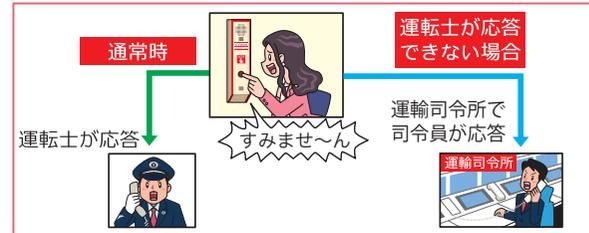
車内非常通報ボタンは、1車両に1～4カ所設置されています。ボタンを押すと運転士が応答します。運転士が応答できない場合は運転司令所に自動で転送され、運転司令所の司令員が応答します。
