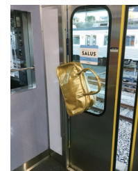
ドアの戸袋にカバンが 引き込まれた様子
