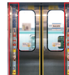
引き込まれにくい すべる素材を使用した、 車内ドアステッカー
