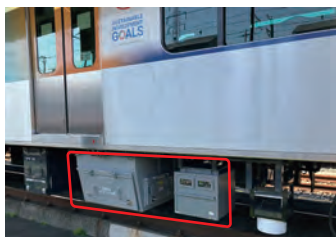
線路設備モニタリング装置
