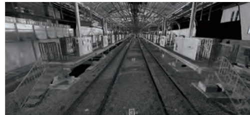
取得した3次元点群データの事例
