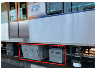
線路設備モニタリング装置
