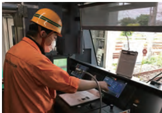
車両を制御する運転台点検
