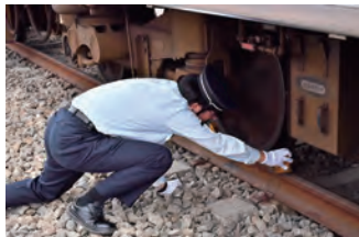
運転士による床下点検
