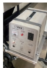
可搬式予備蓄電池
