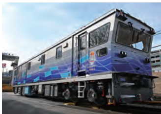
超音波レール探傷車
