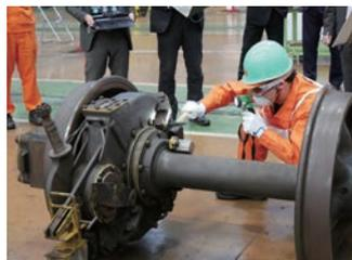
車両部門での技能競技会：車輪の打音検査作業
