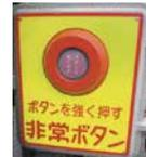
踏切内に人や車が立ち往生してしまったときなど緊急の場合に、非常ボタンを押すと、特殊信号発光機が赤く点滅して接近する列車の運転士に異常を知らせます。東急線内全ての踏切に設置しています。
