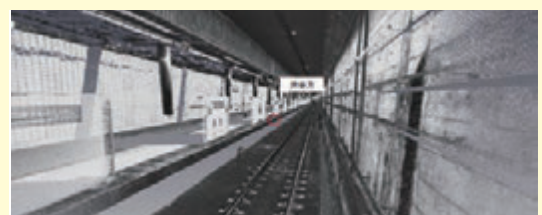
取得した3次元点群データの事例
