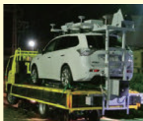
レーザースキャナを搭載した計測車両を軌陸車に載せ、3次元点群データを取得しています
