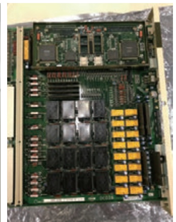
ショートが発生した電子基板
