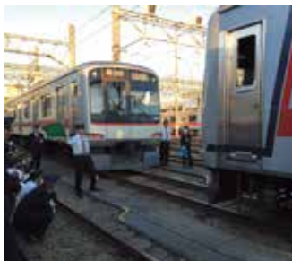
手旗での入換合図による車両の併結を行っている様子
