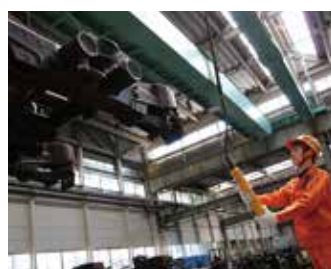
台車の点検：点検が終了した台車を組み立てます
