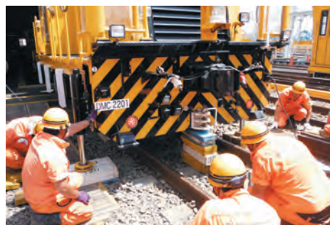
保線部門での技術伝承の一例：夜間作業で活躍する保守用車について方がーのトラブルに備え、年に2回脱線復旧訓練を実施し、異常時に対応できるスキルを身に付けます
