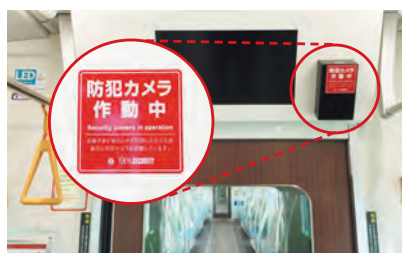
車内の防犯カメラ
