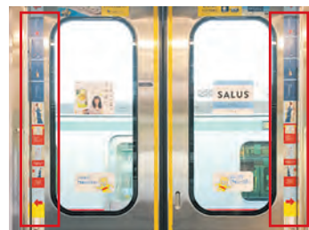
ドア引き込まれ注意喚起ステッカー
