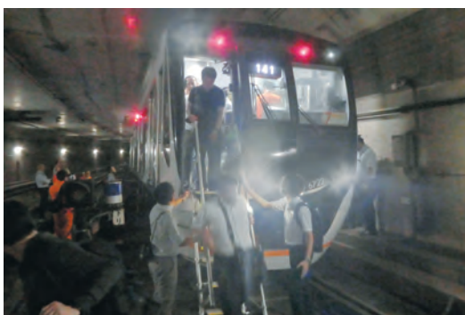
列車前面の非常梯子を使用してお客さまを誘導している様子
