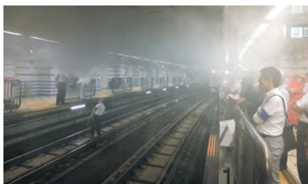
荏原中延駅では火災を想定し、排煙装置の検証を実施した
