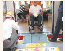
新しいスロープ板の検証
