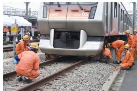
車両係員は回転できない車輪(車軸)を持ち上げ、自走させるための装置を設置します
