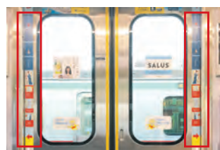
ドア引き込まれ注意喚起ステッカー
