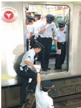
実際の地下区間で列車を緊急停車させ、避難誘導で使用する側面非常梯子を設置している様子
