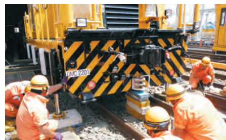
保線部門での技術伝承の一例：夜間作業で活躍する保守用車について万が一のトラブルに備え、年に2回脱線復旧訓練を実施し、異常時に対応できるスキルを身に付けます
