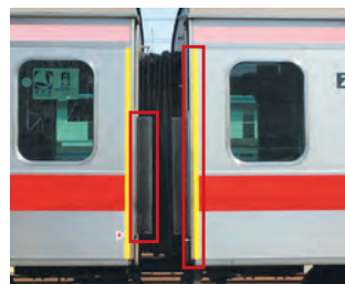
転落防止外幌・注意表示
