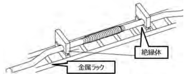
ケーブルとラックの非接触化
