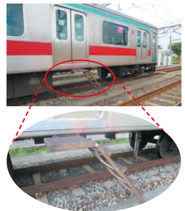
田園都市線5000系の側面非常梯子：側面のドアから避難する際は、車両の床下に設置している側面非常梯子を使用します。
