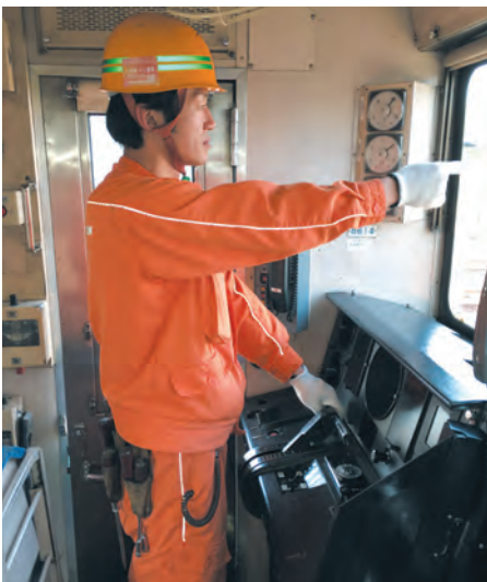
指差換呼による車両機器(ワイパー)の確認
