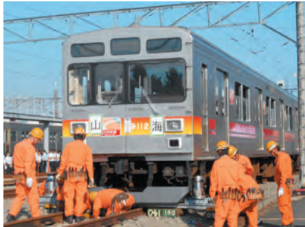
脱線した車両の復旧訓練。油圧ジャッキを使って車両をジャッキアップし、線路上に復旧させます。
