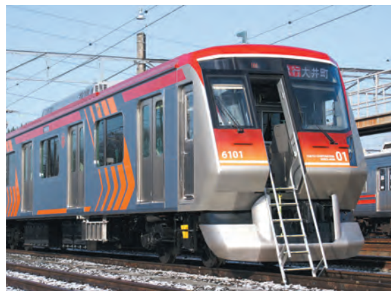
大井町線6000系の正面非常梯子
