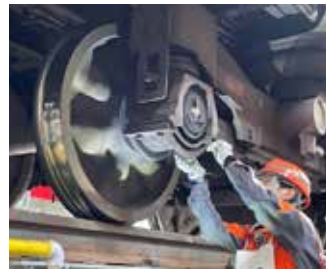
車両部門での技能競技会：床下装置不良箇所修復作業
