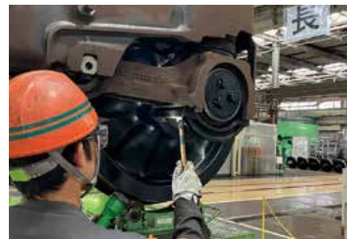
ボルトの打音点検。点検ハンマーの尾端を軽く握り微細な打音・振動の変化を感知して不具合を発見します。
