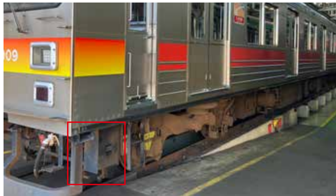
自動ドア非扱い装置 継電器箱
