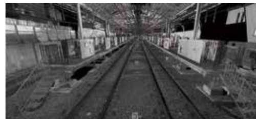
取得した3次元点群データの事例
