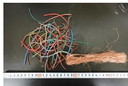
▲湿式剥離法による剥離後の銅線と被覆材
