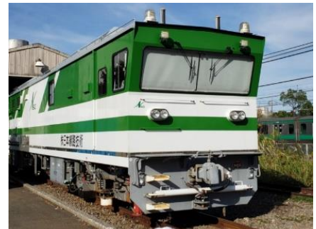
レール内の傷を検査する保守用車
