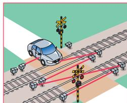
レーザー式踏切障害物検知装置
