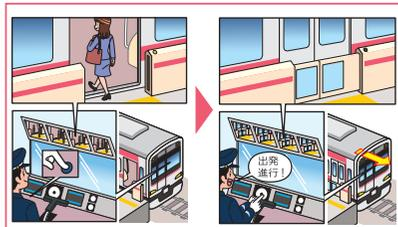
運転席のモニターを確認して運転士がドアの開閉を行います。
