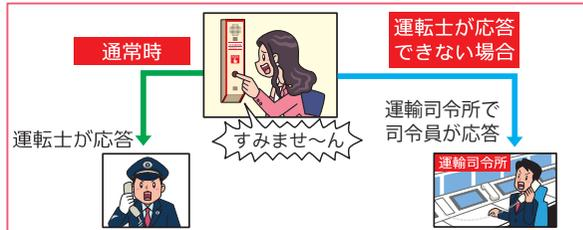
車内非常通報ボタンは、1車両に1～4カ所設置されています。ボタンを押すと運転士が応答します。運転士が応答できない場合は運輸指令所に自動で転送され、運輸指令所の司令員が応答します。
