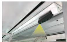
東急電鉄所属の車両に、4Gデータ通信に対応したLED蛍光灯一体型の防犯カメラ「IoTube(アイ・オー・チューブ)」を設置し、車両内のセキュリティ向上を図っています。遠隔地からでも映像を確認することができ、車両内のトラブル発生時には、迅速な対応が可能です。
