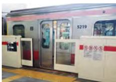
お客さまがホームから転落したり、列車と接触したりする事故を防止するため、東横線・目黒線・田園都市線・大井町線の全駅にホームドアを設置しています。また、池上線・東急多摩川線の全駅には、センサー付固定式ホーム柵を設置しています。ホームドアにはセンサーが設置されており、閉まりかけた際に人や荷物を感知するとホームドアが開きます。また、ホームドアが正常に閉まったことを確認できないと列車が発車できない仕組みとなっています。
