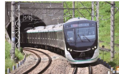
旧型車両よりも使用電力量を50%削減した2020系車両
