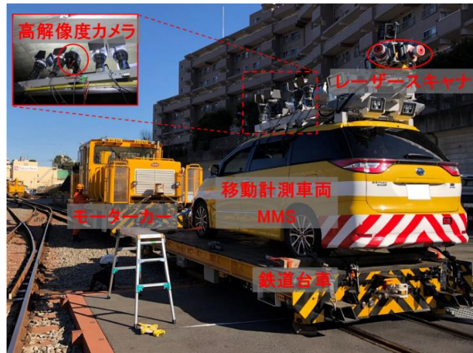
▲鉄道台車に搭載した移動計測車両「MMS」 (2019年1月田園都市線での実証実験時)
