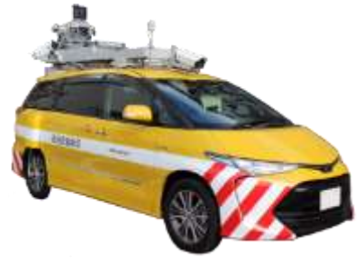
3次元点群データ計測車両
