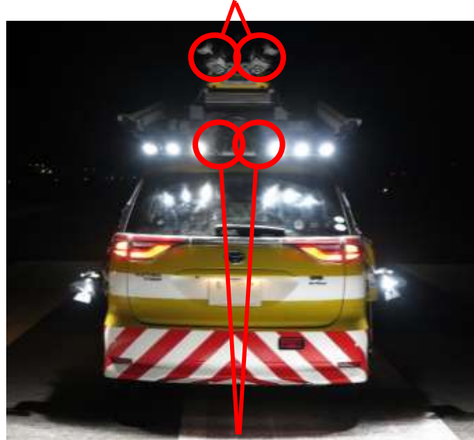
ラインセンサカメラ(ひび割れの検出)
