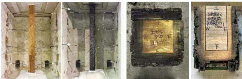
試験前の耐火柱
