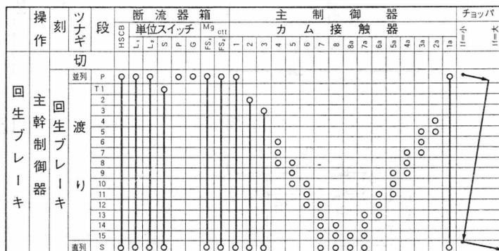
電動ノッチ曲線 8個MM制御時
