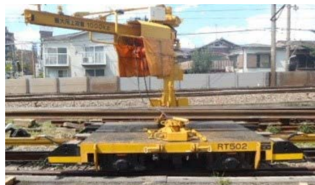
2009年 レール運搬車 自重5t 全長2,600mm 全幅2,050mm
