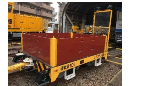
2010年 トロ口台車 自重3.5t 全長3,130mm 全幅1,970mm
