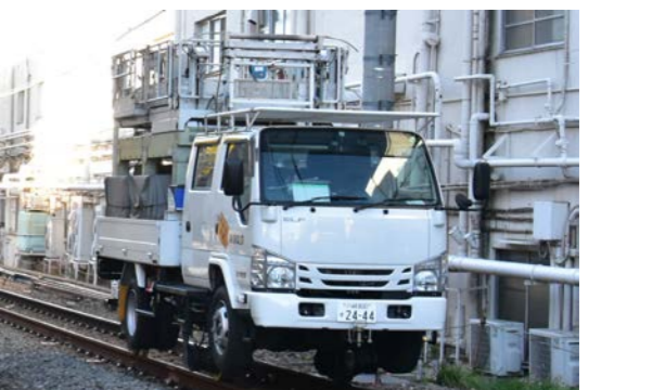
架線整備車 (軌陸車)
