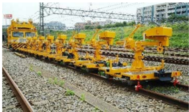
2016年 ロングレール運搬車 自重1t 全長2,000mm 全幅1,600mm
