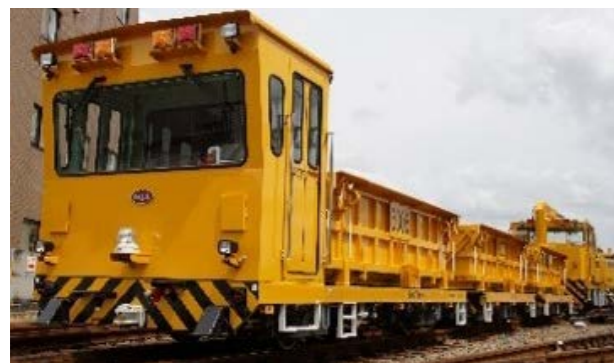
2014年 残土運搬車 自重9t(7.5t)* 全長6,520(4,960)*mm 全幅2,460(2,300)*mm
