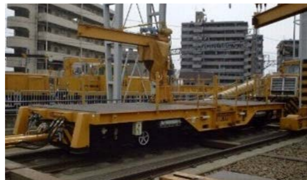
1990年 レール運搬車 自重18t 全長8,740mm 全幅2,600mm
