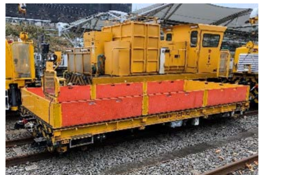
2011年 資機材運搬車 自重7t 全長6,750mm 全幅2,630mm
