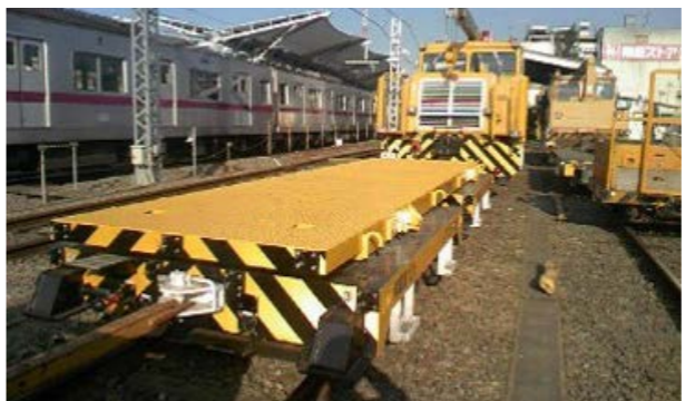
2014年 PCマクラギ運搬台車 自重1.5t 全長6,000mm 全幅1,700mm
