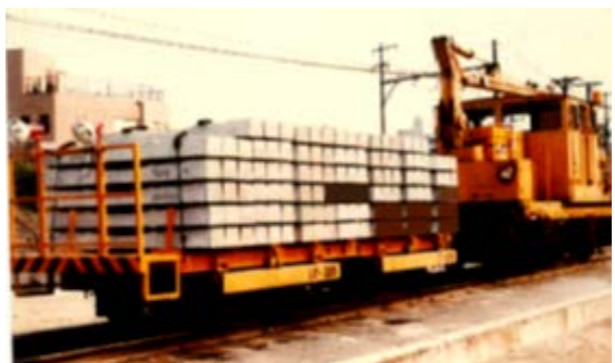
1970年 PCマクラギ運搬台車 自重2t 全長不明 全幅不明
