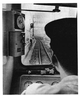
ATS (自動列車停止装置) の車上装置
