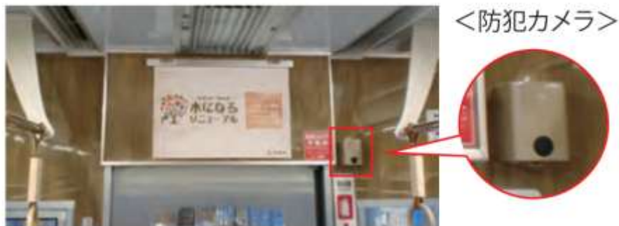
池上線・東急多摩川線1000系に搭載した車両内防犯カメラ
