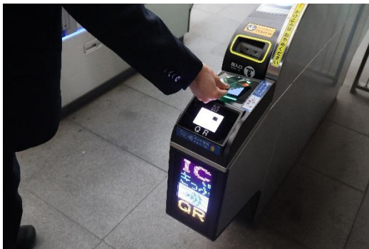
▲「クレジットカードのタッチ決済」・「QRコード」に対応した改札機
