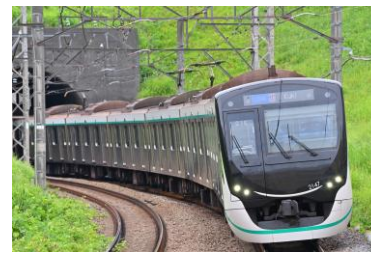
旧型車両よりも使用電力量を50%削減した2020系車両
