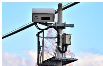
▲3Dセンサー式障害物検知装置
