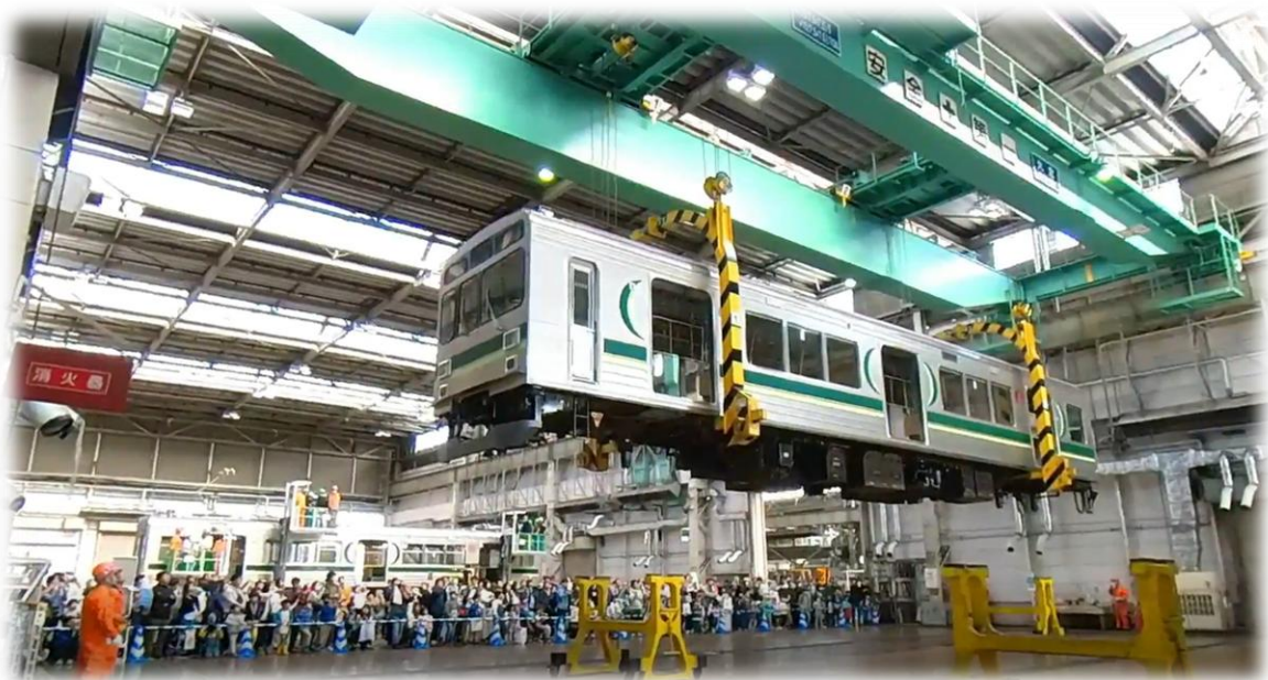
車両メンテナンスの実演(車両吊上げ)
