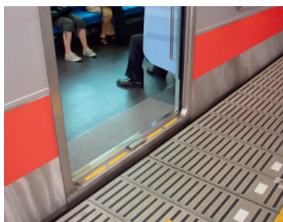
床面とホームの段差を小さくした車両
