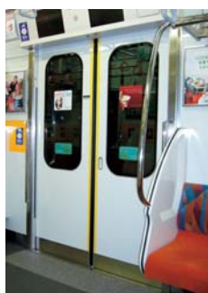
扉の縁を着色して注意を促し、複層ドアガラスで防音と結露防止を実現
