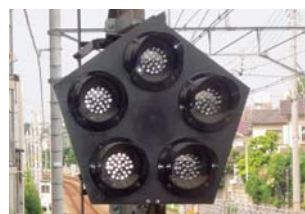
特殊信号発光機 非常ボタンが押されたり障害物検知装置が異常を検知したときに、赤く点滅して列車の運転士に異常を知らせます。ATCと連動しているため、東横線、目黒線、大井町線、こどもの国線では、接近する列車を自動的に減速させます（田園都市線に踏切はありません）。
