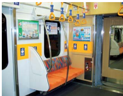
扉の縁を着色して注意を促し、複層ドアガラスで防音と結露防止を実現
