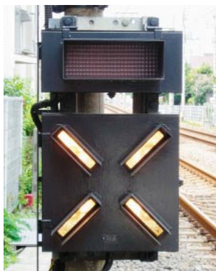
踏切動作反応灯 遮断かんが確実に降りていることを、接近する列車の運転士に知らせます。
