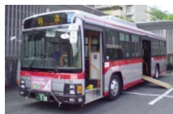
ワンステップバス 乗降口のステップが1段で、従来の2段ステップに比べて乗降しやすくなっています。中扉には車いすでご利用のお客さまのためにスロープ板を装備しています。(2008年3月現在 229両)
