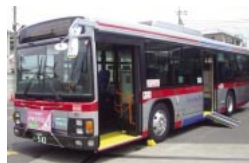
ノンステップバス 乗降口にステップがないことに加え、車高を下げる機能により、容易に乗降でき、中扉には車いすでご利用のお客さまのためにスロープ板を装備しています。(2008年3月現在 474両)
