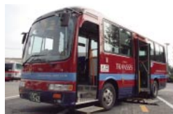
リフト付バス 中扉に車いす乗降用の電動リフトを装着しています。(2008年3月現在 14両)
