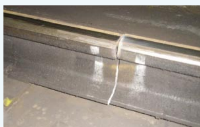
レールを溶接した箇所が損傷
