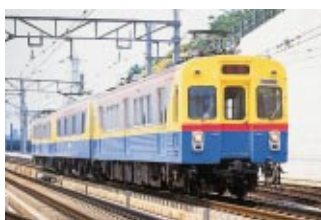
高速軌道検測車で線路の状態を測定します
