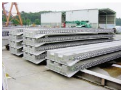
工事に使われたハーフプレキャストスラブ（上）と現場の施工状況（右）
