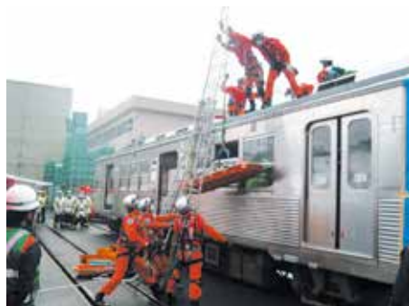
トンネルや橋梁など、側面からの救出が困難な場合の屋根からの救出訓練。廃車車両を使い、車両の屋根をカッターで切断し、車内に取り残されたお客さまを救出します
