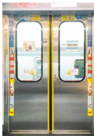
ドア引込まれ注意喚起ステッカー(全体)
