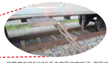
田園都市線5000系の側面非常梯子：側面のドアから避難する際は、車両の床下に設置している側面非常梯子を使用します
