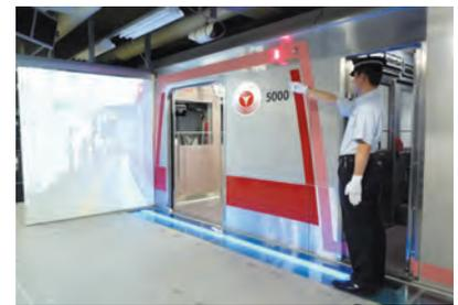
車掌シミュレーターを用いた車掌の訓練の様子
