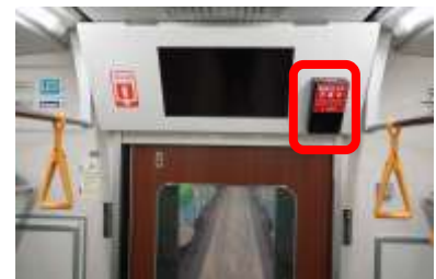
車内防犯カメラ(設置例)
