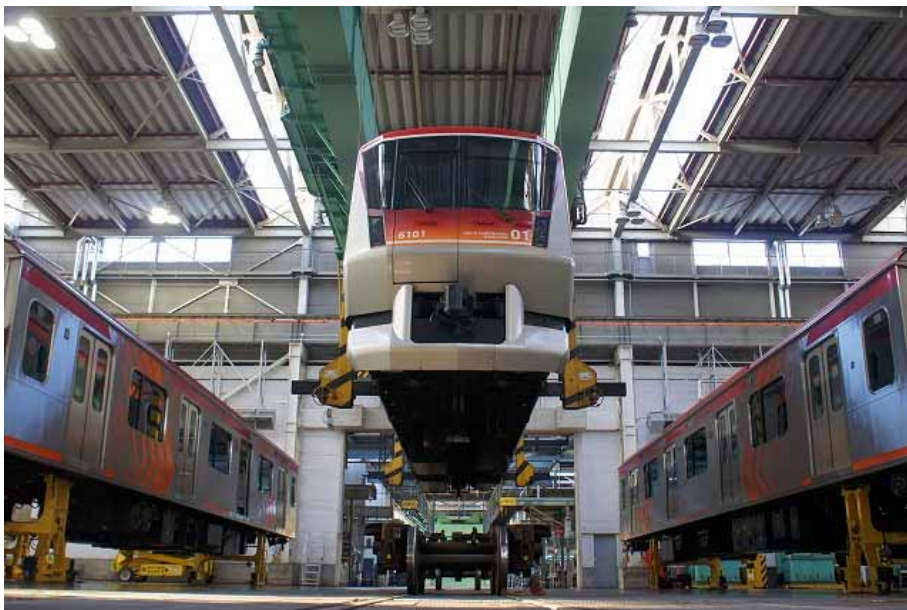
検査のため、クレーンで台車から外される車体
