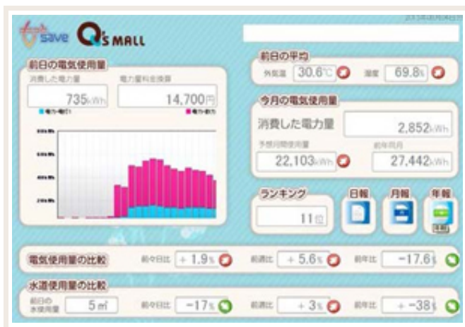
クラウド型BEMSによる「エネルギーの見える化」
