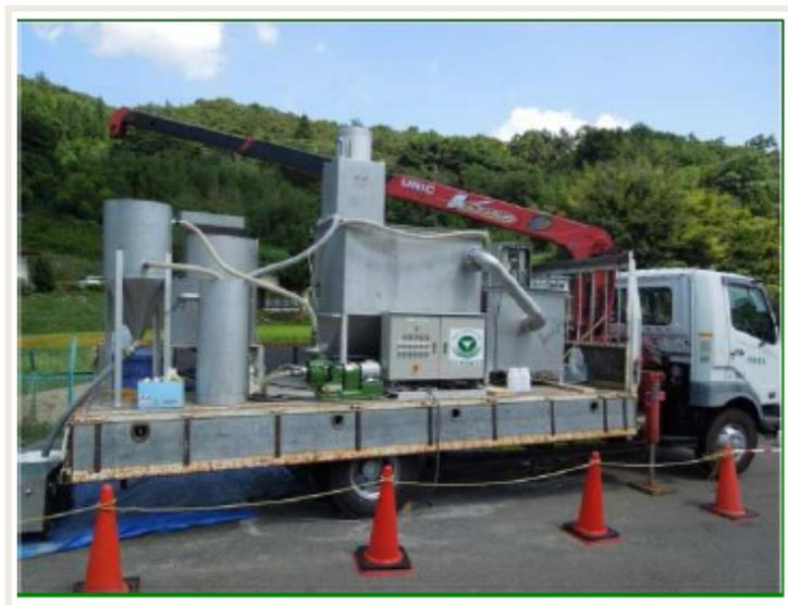
4~10トントラックに積載可能で、装置を荷下ろしせずに水処理を行うことができる。
