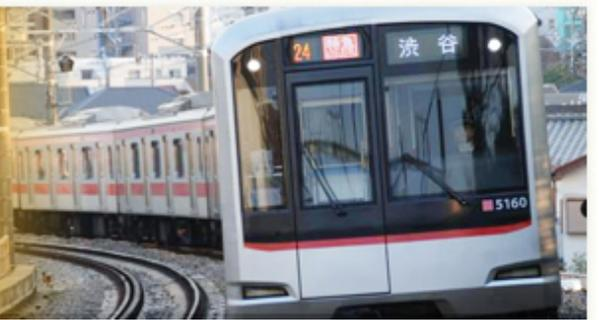
鉄道は、CO<sub>2</sub>排出量の少ない環境負荷の低い乗り物です。当社では、車両への電力回生ブレーキの導入率について2011年度から100%を継続しています。また、従来車両に比べ使用電力を約40%削減した新型車両の導入や、駅施設の照明のLED化など、省エネルギー対策に積極的に取り組んでいます。
