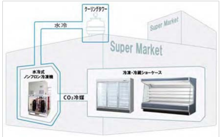
「水冷式ノンフロン冷凍機システム」の仕組み図
