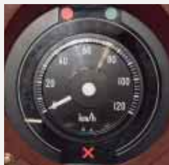
車内信号機 (ATC) 非常停止信号受信時
